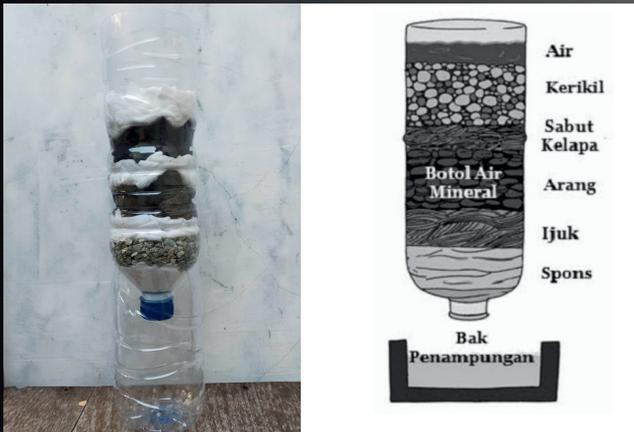
Gambar diagram pembuatan alat penyaringan air sederhana
